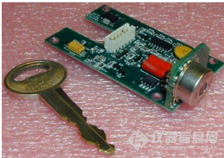
图 20. 标准的 XR-100 前放，长 60mm，宽 30mm。
