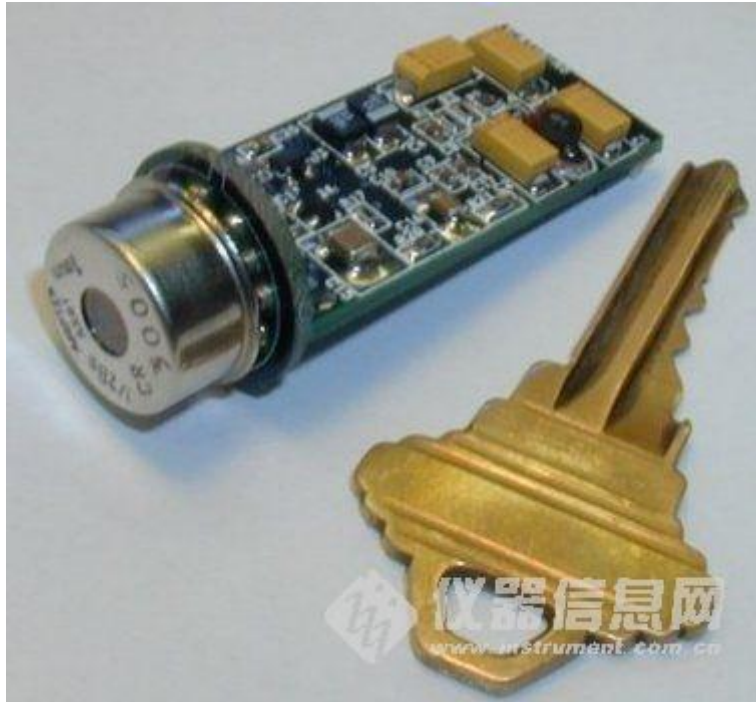
图 13. PA-210 型前放, 直径 18mm, 长 40mm。
