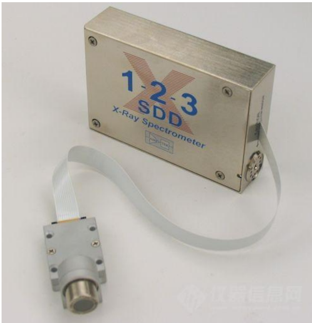
图 19. 封装好的 PA-230 前放和改版 X-123（已通过软排线连接）。
