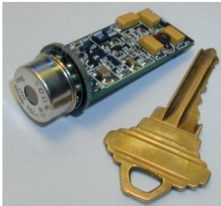
图 5. PA-210 型前端放大器，直径 18mm，长 40mm
