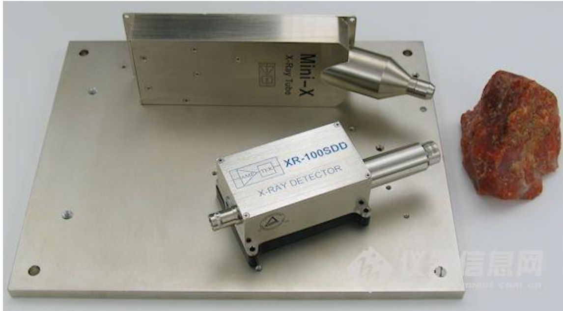
图 19. 安装于 MP1 型平板上的 XR100SDD 探测器和 Mini-X 发生器
