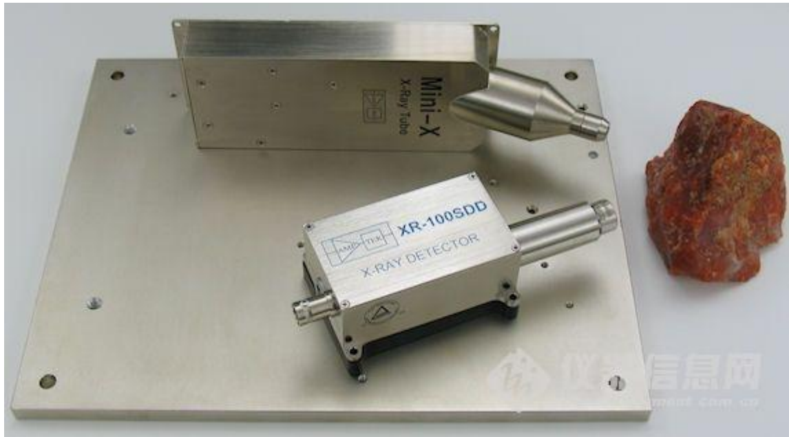
图 12. XR100CR 和 Mini-X 安装在 MP1 平台上示意图
